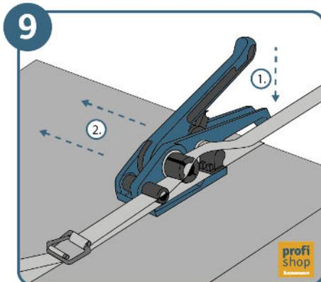
Wenn die gewünschte Spannung erreicht ist, drücken Sie den Spannhebel nach unten. Auf diese Weise schneiden Sie mit dem Messer das Umreifungsband durch und können den Haspelspanner anschließend wegnehmen.
