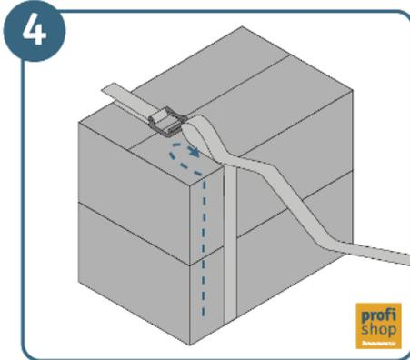
Nehmen Sie das auf der Rolle verbleibende Umreifungsband, um eine Schlaufe zu bilden. Diese führen Sie mittig durch die Klemme. Achten Sie darauf, dass der untere Teil der Schlaufe zum Packgut und der obere zur Rolle führt.
