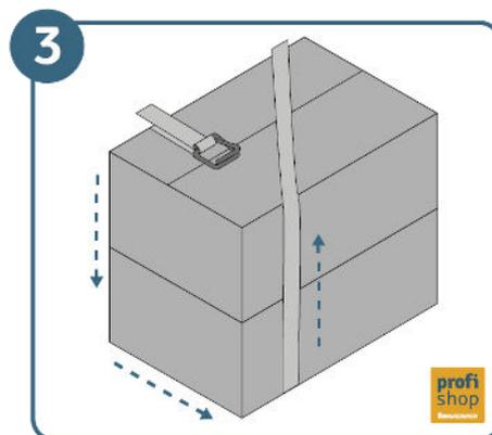
Legen Sie das Umreifungsband möglichst eng um die Kartons. Achten Sie bei Paletten darauf, dass die einzelnen Packstücke eng nebeneinander liegen, sodass sie nicht nachträglich verrutschen können. Außerdem müssen scharfe Ecken und Kanten zusätzlich abgesichert werden, um zu verhindern, dass das Band einschneidet oder beschädigt wird.
