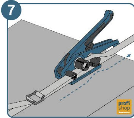
Anschließend führen Sie das obere Band **durch Messer und Klemmwalze** des Haspelspanners.
