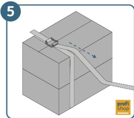
Legen Sie die Schlaufe um das freie Ende der Drahtklemme und ziehen Sie das obere Ende des Bandes an, bis es dicht am Packgut anliegt.
