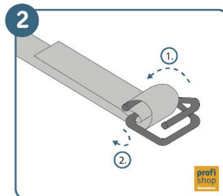
Führen Sie den Bandanfang durch die Klemme und zwischen zwei Drahtbügeln zurück, sodass beide Bandstücke übereinander liegen und die Klemme fest am Band hält.
