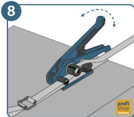
Während Sie mit einer Hand das Band und den Spanner festhalten, bewegen Sie mit der anderen den Spannhebel so lange hin und her, bis das Umreifungsband straff gespannt ist.
