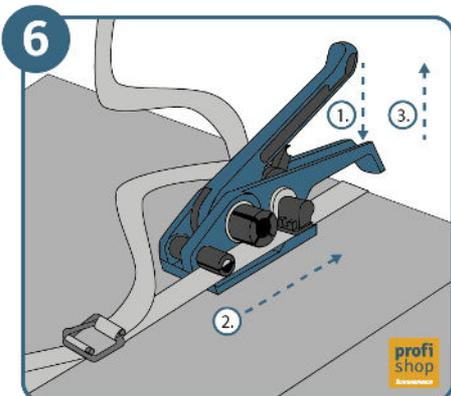
Im Abstand von etwa 20 bis 30 Zentimetern zur Drahtklemme legen Sie nun das untere (am Packstück anliegende) Band in den Haspelspanner. Dazu drücken Sie den Griff des Haspelspanners nach unten und legen das Band **unter Messer und Klemmschuh** des Spanners. Sobald die Position stimmt, lassen Sie den Griff des Haspelspanners wieder los.
